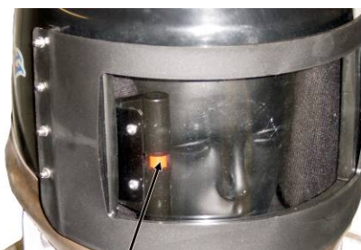
INDICATORE DI FLUSSO D'ARIA CON SEGNALE ROSSO, FLUSSO D'ARIA INSUFFICIENTE
